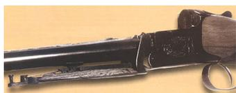
*Разрушение верхнего ствола, части затворной коробки и цевья ружья ИЖ-27 в результате выстрела патроном «магнум» (длина гильзы 76 мм) со стальной дробью без контейнера*
