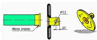
Предлагаю, на мой взгляд, интересное дополнение к экипировке охотника - пуговицы из стреляных бумажных или пластмассовых охотничьих гильз. У гильзы (см. рис.) любым способом (лучше узким отрезным резцом на токарном станке) обрезается трубка, а в капсюле сверлится отверстие. Для водостойкости поверхность пуговицы с обратной стороны следует покрыть в два слоя любым пленочным клеем.
