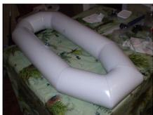
Сначала надо сделать лекала и опробовать их на небольшой модели. Можно склеить лодку из обычных полиэтиленовых пакетов. Стоит попробовать склеить и маленькую лодку для того, что бы «почувствовать материал»
