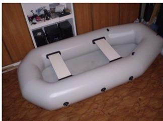
При изготовлении самодельной лодки из ПВХ внимательно ознакомьтесь с инструкцией по склеиванию. Лучше всего использовать двухкомпонентные клей для ПВХ, однокомпонентные клей норовят начать сохнуть сразу после открытия тюбика и если вы не используете весь тюбик за один раз, то через некоторое время клей станет непригодным для использования.
