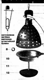
Рис.7. Крепление: 1 - заставка вертикального; 2 - вертикальное; 3 - шпилька; 4 - крышко; бутылка; 5 - "узелок"; 6 - корпус; 7 - заставка; 8 - заставка; 9 - ушко; 10 - отпавное дно; 11 - заставка; 12 - груз.
